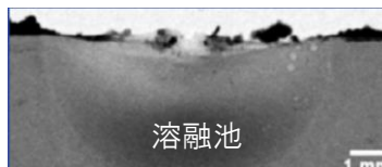
X線による溶融池生成観察 (SPRing-8)
