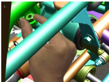
作業性の確認 （作業空間の確認）
